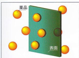
手袋素材への薬品の浸透時間の測定は、手袋への完全浸透を条件とします。
